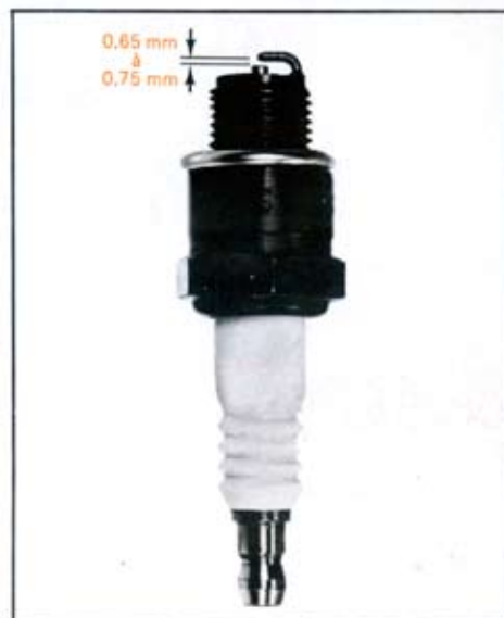
Fig. 8 Bougies : Ecartement des électrodes
