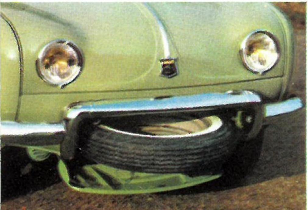
Roue de secours disposée sous le coffre à bagages, dans un logement spécial fermé par la plaque de police. Déverrouillage commandé de l'intérieur du coffre (sécurité contre le vol).
