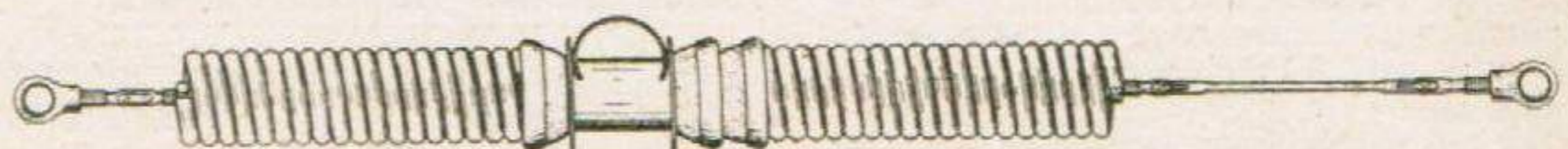
Fig. 34. — Vue de la suspension avec ressorts apparents.
