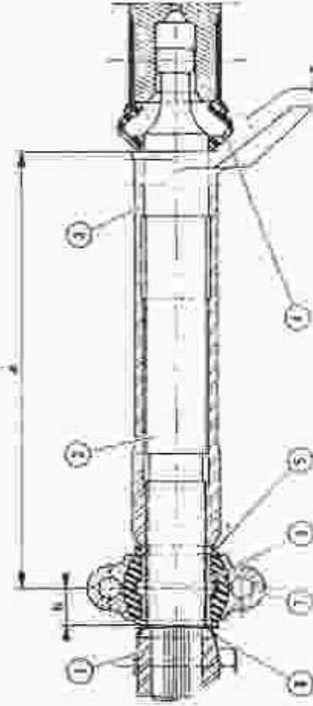
Fig. 7. — Vue en coupe de l'arbre de renvoi de débrayage
