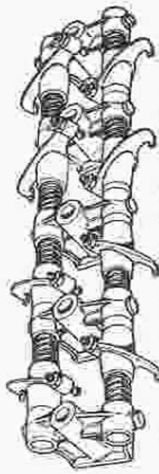
Fig. 1. — Rampe de culbuteurs unifiée, après dépose.
