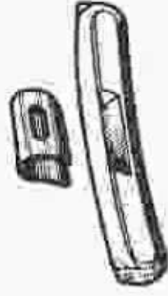
FIG. 26. — Masselottes d'équilibrage à ressort indépendantes.
